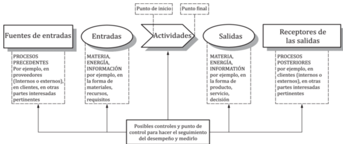
Imagen 1. Representación esquemática de los elementos de un proceso.
