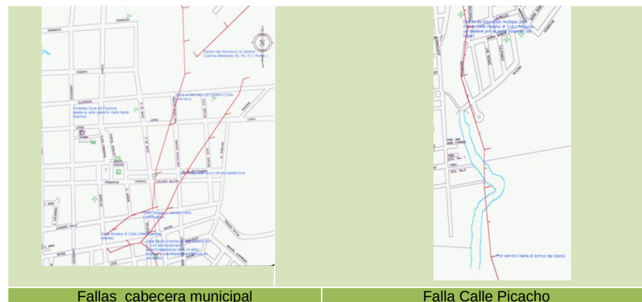
Imagen 46.- Fallas en la Cabecera Municipal Fuente: Elaboración propia Arqurbe, datos de Protección Civil Municipal 58
